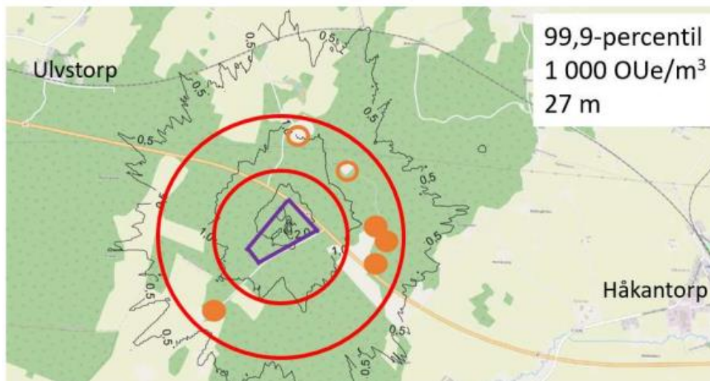
Bild 21: Spridningsbild för lukt, 99,9-percentil vid modellerade förhållanden enligt fall 2 (utsläppsnivå 1000 OUe/m 3 +27 meter). Alla markerade och närmaste bostäder kommer i zonen 0,5 – 1 OUe/m 3 .
