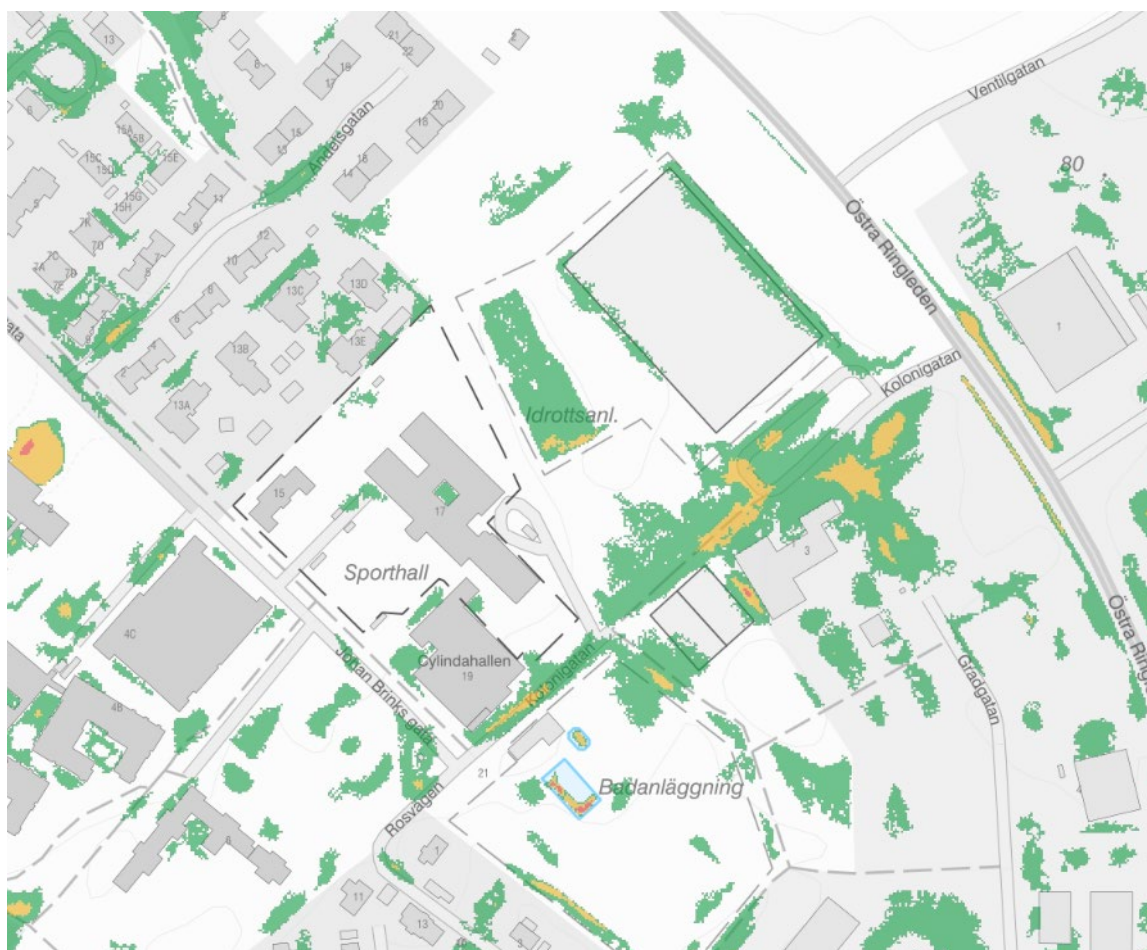
2Bilden ovan är ett skärmbild från Scalgo som redovisar hur ett skyfall påverkar planområdet och angränsande bebyggelse idag. Flödena är beräknade utifrån ett 100 års regn motsvarande 50 millimeter. Grönt 0-20cm, gult 20-50cm, rött >50cm.
